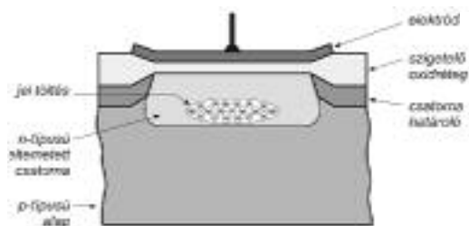
1. ábra CCD cella keresztmetszet – a cellasor csatornájára merőlegesen
